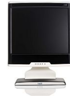
Postazione con eye traker montata sulla cornice del display
